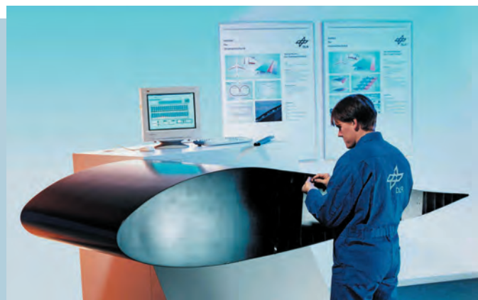
Abbildung: Funktionsdemonstrator für eine flexible Hinterkantenklappe und variable Konturaufdickung im DLR-Institut für Aeroelastik ( www.dlr.de )
